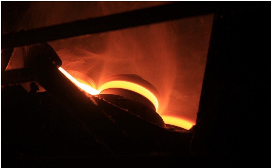
Рисунок 2 – Процесс натекания струи на валки центрифуги
