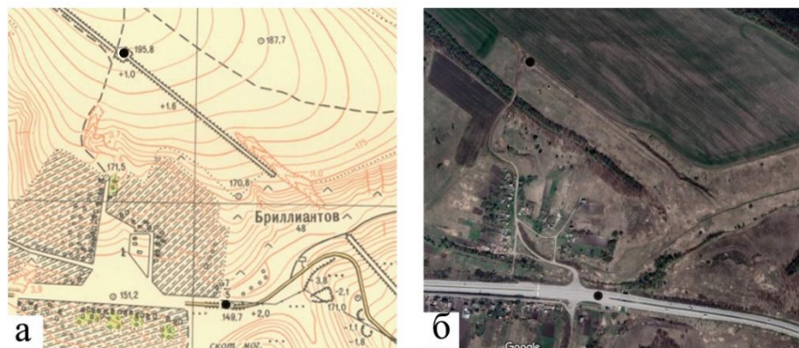
Рисунок 5. Расположение реперной точки и измеряемые отрезки между реперной точкой и двумя вершинами оврага по состоянию на 1955 год (а) и 2018 год (б)
